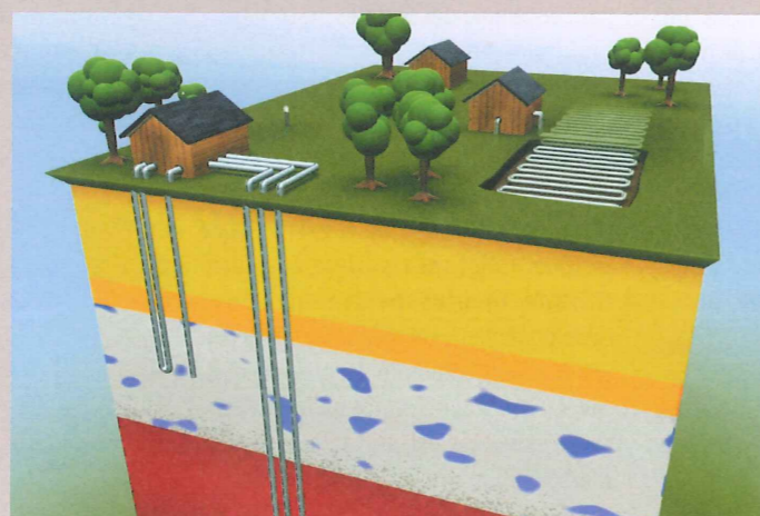
Légende : Plateforme expérimentale BRGM pour les échangeurs enterrés des pompes à chaleur géothermiques
